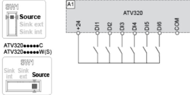
Conmutador SW1 fijado en posición "fuente" y uso de una fuente de alimentación externa para las entradas digitales.
