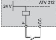
Posición "PLC" con salidas de transistor de PLC
