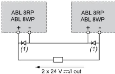
(1) Dos diodos Shottky  $I_{min}$  = fuente de alimentación  $I_n$  y  $V_{min}$  = 50 V
